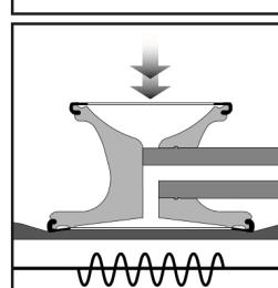
**Vysoké frekvencie:** vyvierte na hrudný snímač väčší tlak
