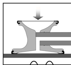
**Nízke frekvencie:** vyvierte na hrudný snímač malý tlak
