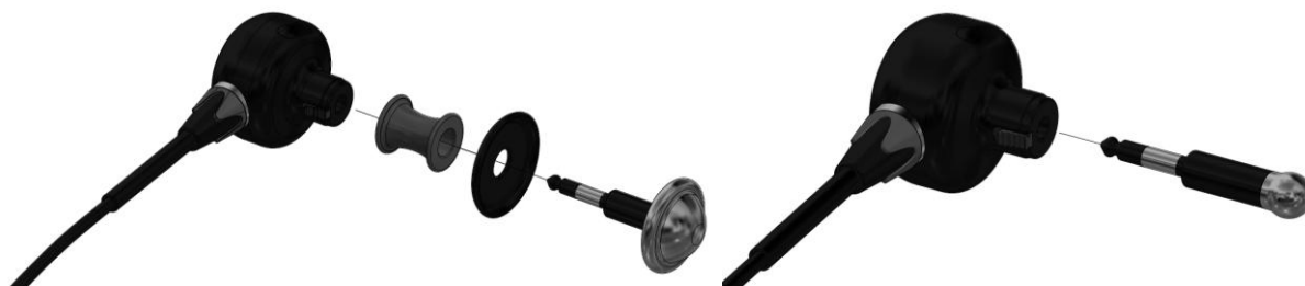
Obrázok 7.6. Pripojenie konvexných rezistívnych elektród k uhlovému aplikátoru
